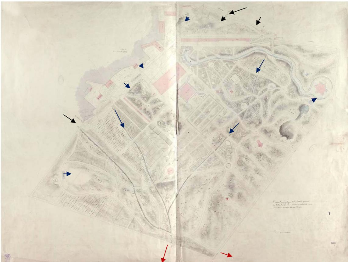
Plano de 1845 señalando las entradas y salidas de agua conocidas y dirección de la circulación en el interior de la misma proveniente de sus norias y estanques.
