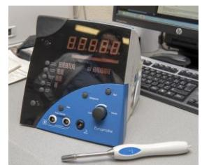
Con dos módulos de lectura y cuatro detectores, uno de detección externa inalámbrico, fundamentalmente para  $^{99m}\text{Tc}$ ; dos de detección externa con amplio margen de energías, incluido PET; uno de detección laparoscópica para  $^{99m}\text{Tc}$ .
