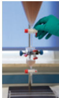
Fig. 21. Extraer 30 ml sobrenadante.
