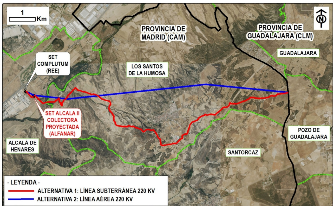
CROQUIS COMPARATIVO DE ALTERNATIVAS. Fuentes: Datos.gob.es. Servicio de visualización wms de ortofoto PNOA
