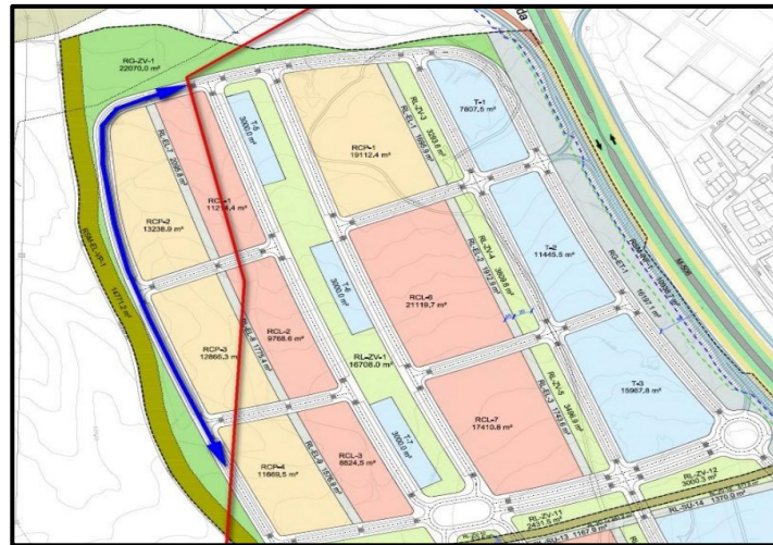
Figura : Línea roja trazado aéreo de la LASAT del PEI. Línea azul trazado soterrado propuesto. Fuente: Alegación Comisión Gestora "UZ-5 Camino de Sacedon y UZ-6 Calatalifa", de Villaviciosa de Odón.
