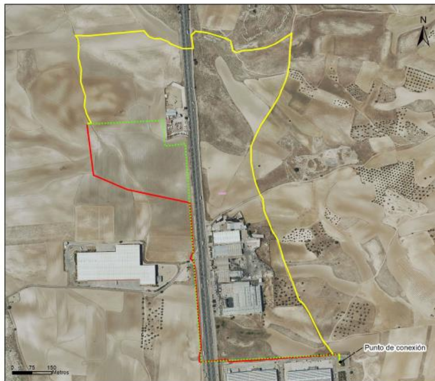
Alternativas de línea de evacuación MT 15 kV
