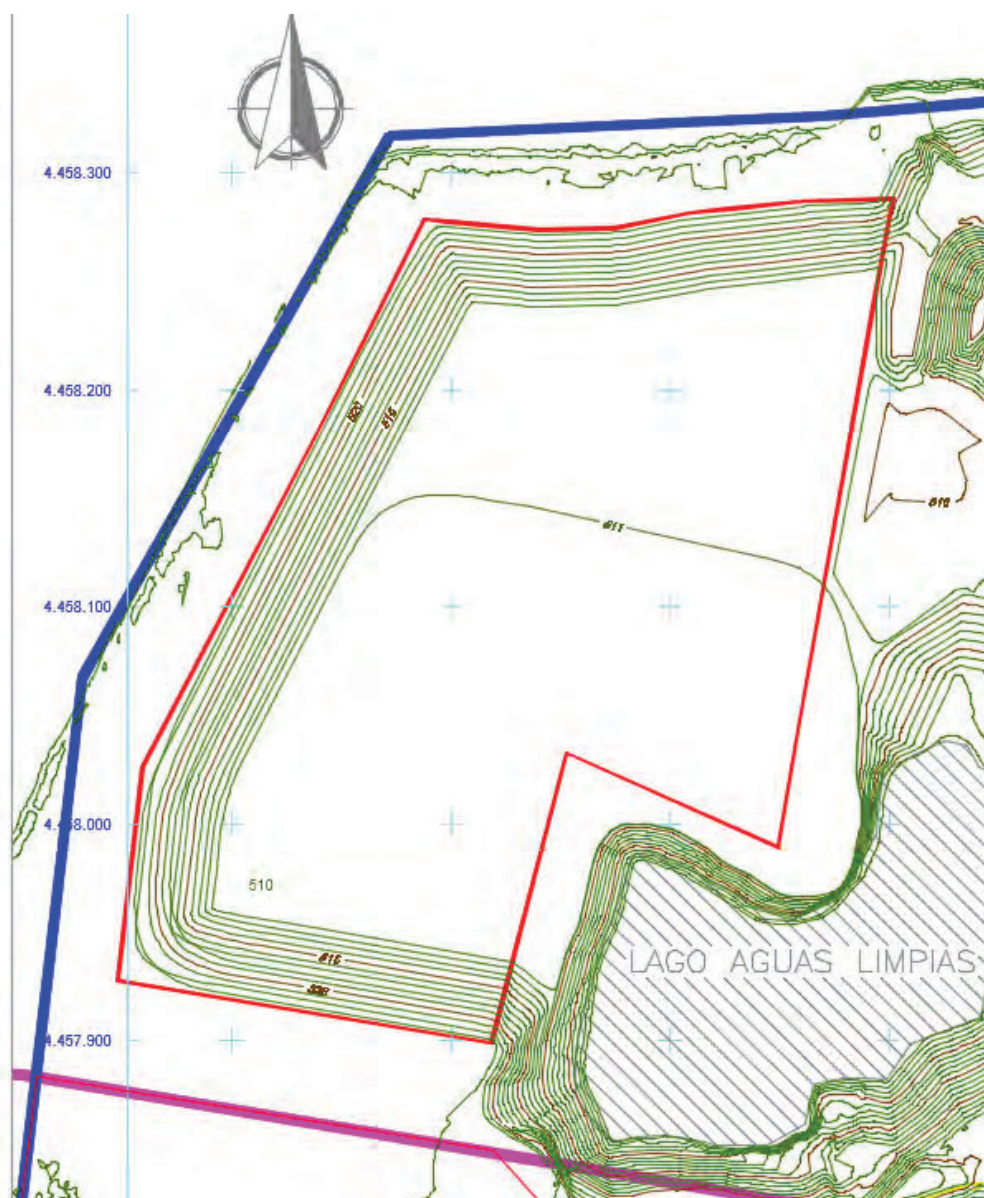
Figura 43. Estado restaurado con relleno a cota 511 m y taludes 3 (H) : 1 (V)
