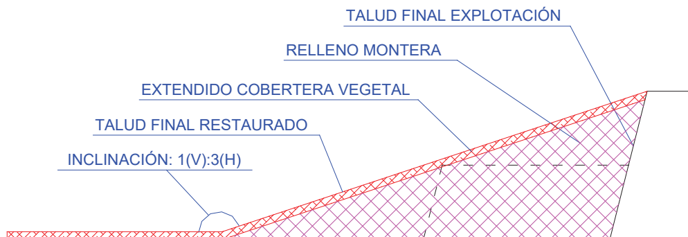
Figura 12. Talud final restaurado.
