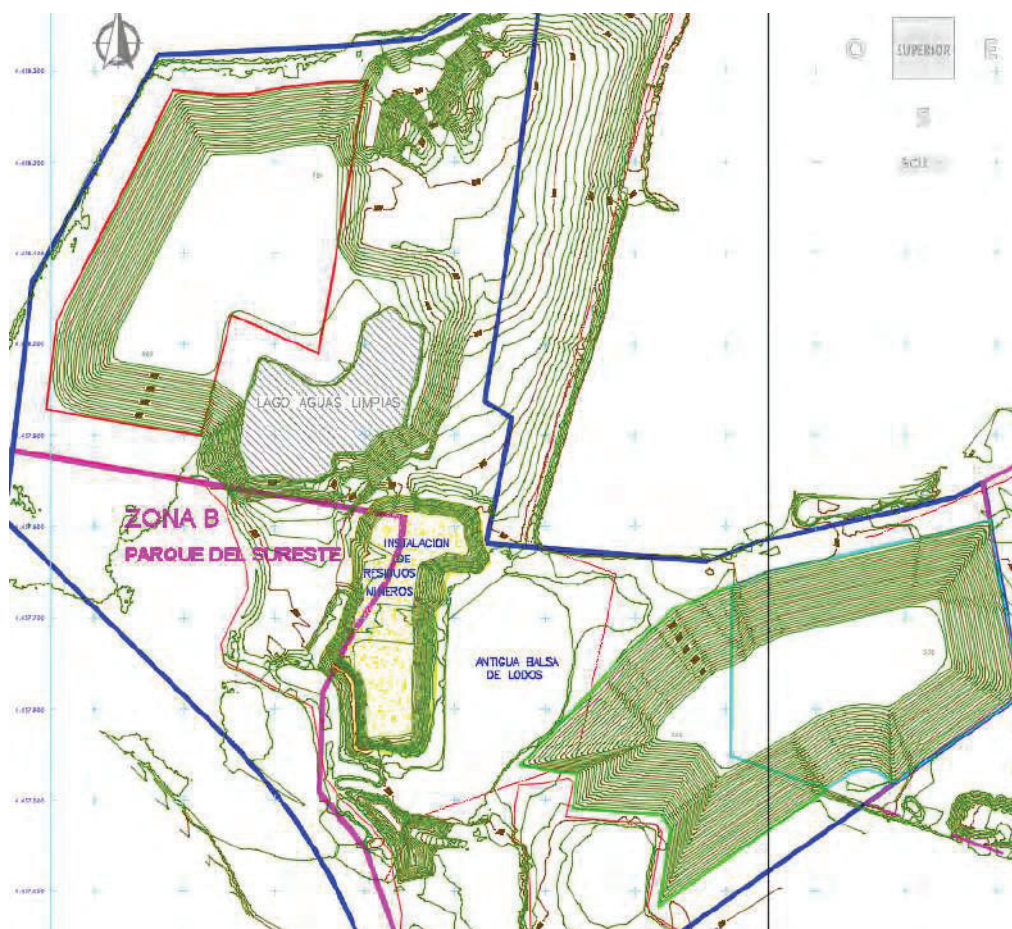
Figura 42. Estado final restaurado con taludes 3(H) : 1 (V)
