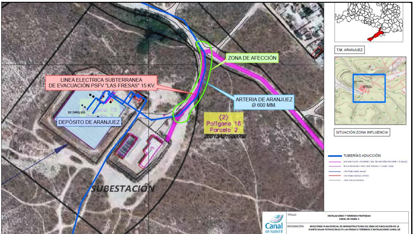
Afecciones a las infraestructuras del Canal de Isabel II. Fuente: Canal de Isabel II.
