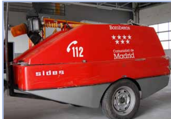
REMOLQUE GENERADOR ELÉCTRICO RGE 3 unidades
