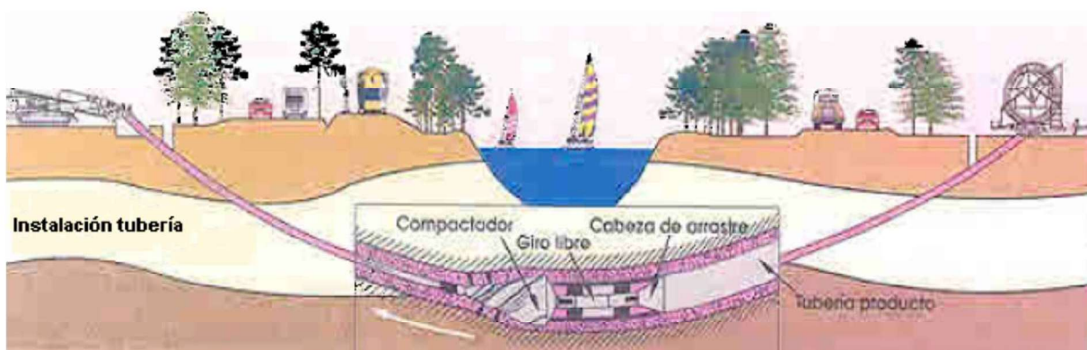
IMAGEN 6. INSTALACIÓN DE LA TUBERÍA.
