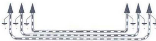
Ilustración 17. Puesta a tierra de cubiertas metálicas
