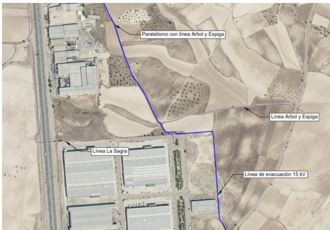
Ilustración 19: Afecciones con líneas eléctricas existentes (1).
