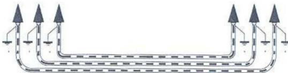
Ilustración 29. Puesta a tierra cubiertas metálicas
