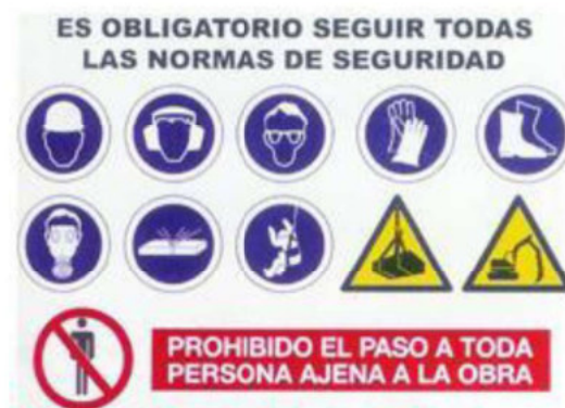
IMAGEN 1. Señalización sobre las normas de seguridad de la obra
