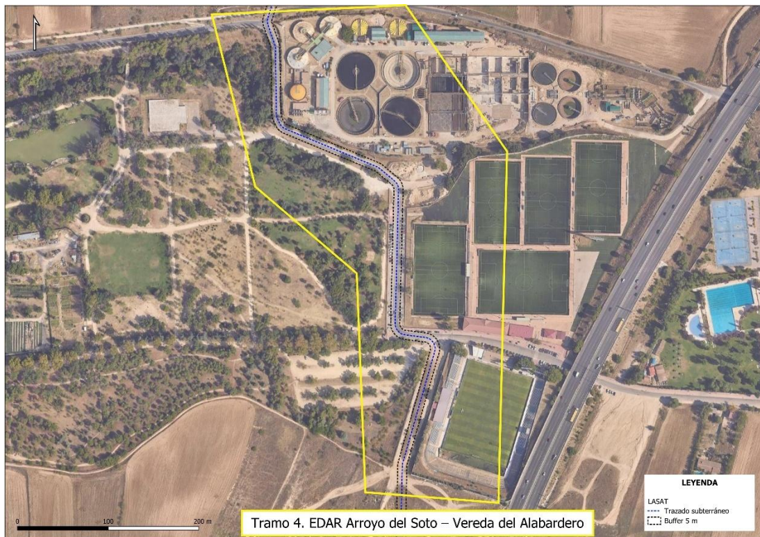
Figura 74. Tramo 4 (EDAR Arroyo del Soto – Vereda del Alabardero) del tramo subterráneo de la línea de evacuación. Fuente: elaboración propia.
