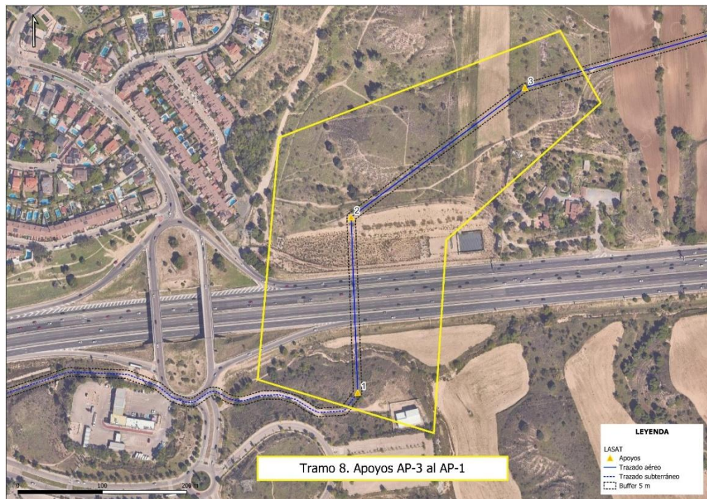
Figura 93. Tramo 8 (Apoyos AP-3 al AP-1) del tramo subterráneo de la línea de evacuación.
