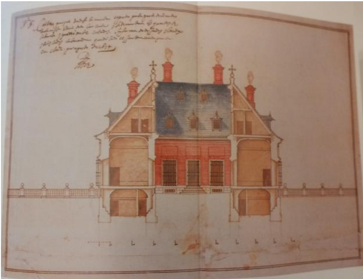
Página 139. En la parte superior, leemos: Corte [corregido sobre "fachada"] pri[n]cipal donde se demuestra el patio, por la part de adentro, / de la Cassa Real de la Çarçuela, y se demuestran los quartos de / lebante y poniente [corregido sobre "mediodía"] cortados, [además de] tejados y bóuedas / y, a los lados, la baranda que divide el jardín con la güerta./ En Madrid, por agosto de 1634.
