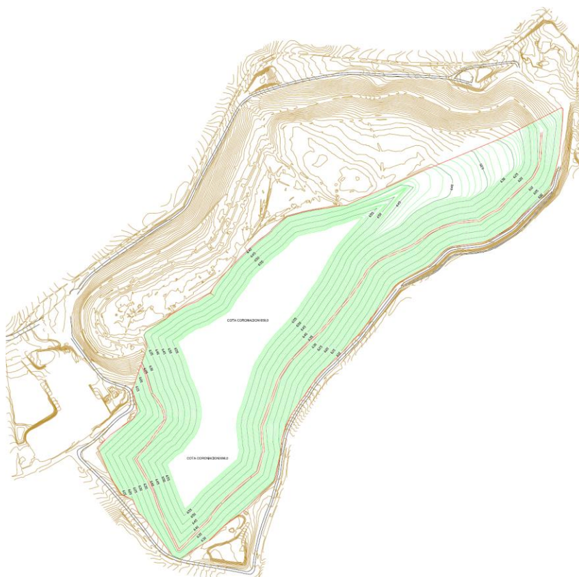
Topografía final: Modelo digital del sellado. Planta (Fuente: Anejo nº 8 del Proyecto de modificación)
