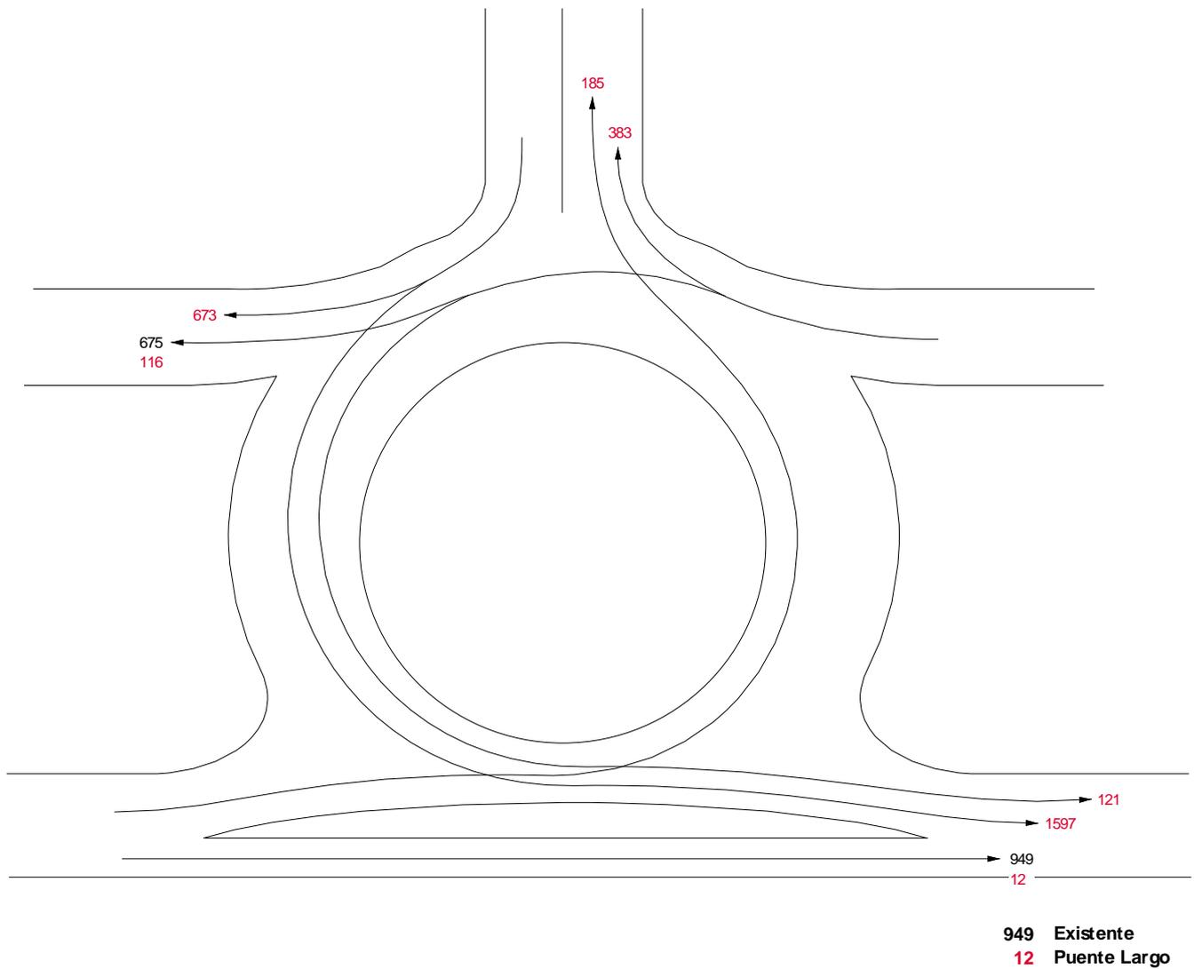
El funcionamiento de la glorieta intermedia de acceso a Puente Largo, con la configuración inicialmente propuesta, reflejado en las tablas adjuntas, resumen de los resultados recogidos en el Apéndice 11, muestra problemas de funcionamiento en el acceso de Aranjuez, en la hora punta de la mañana y en el acceso de Puente Largo, en la hora punta de la tarde.
