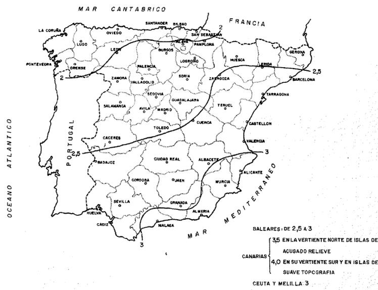
Fig. 2.5. MAPA DEL COEFICIENTE CORRECTOR DEL UMBRAL DE ESCORRENTIA
