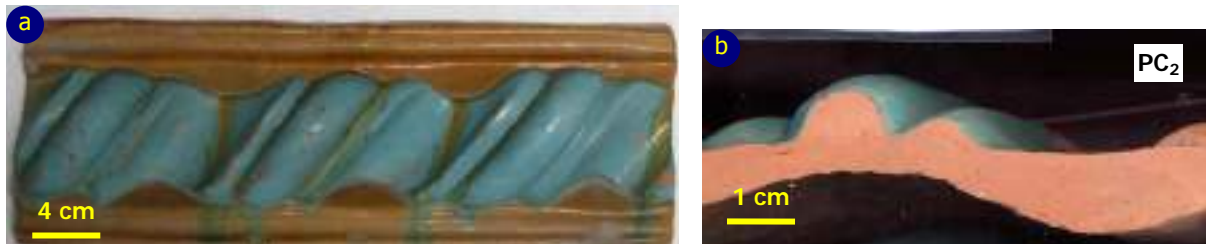
Fig.5.8. Aspecto macroscópico de la pieza cerámica, correspondiente al cordón que enmarca los paneles, elaborada en los años ochenta (muestra PC 2 ) para la sustitución de los paños originales.
