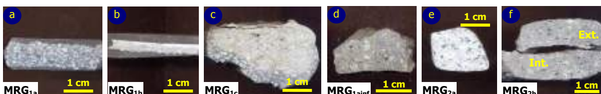
Fig.6.15. Aspecto macroscópico de las tipologías de mortero de revestimiento imitación piedra granítica establecidas in situ MRG 1 y MRG 2 .
