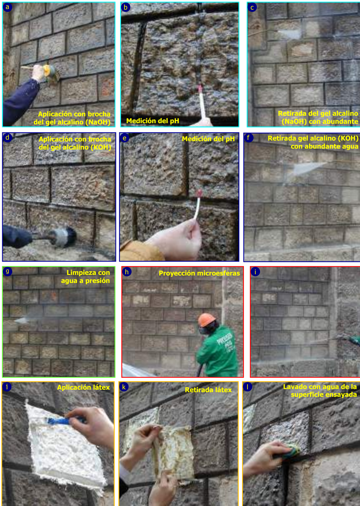
Fig.11.1. Aplicación in situ de los cinco métodos de limpieza ensayados en el muro perimetral (c/Treviño).
