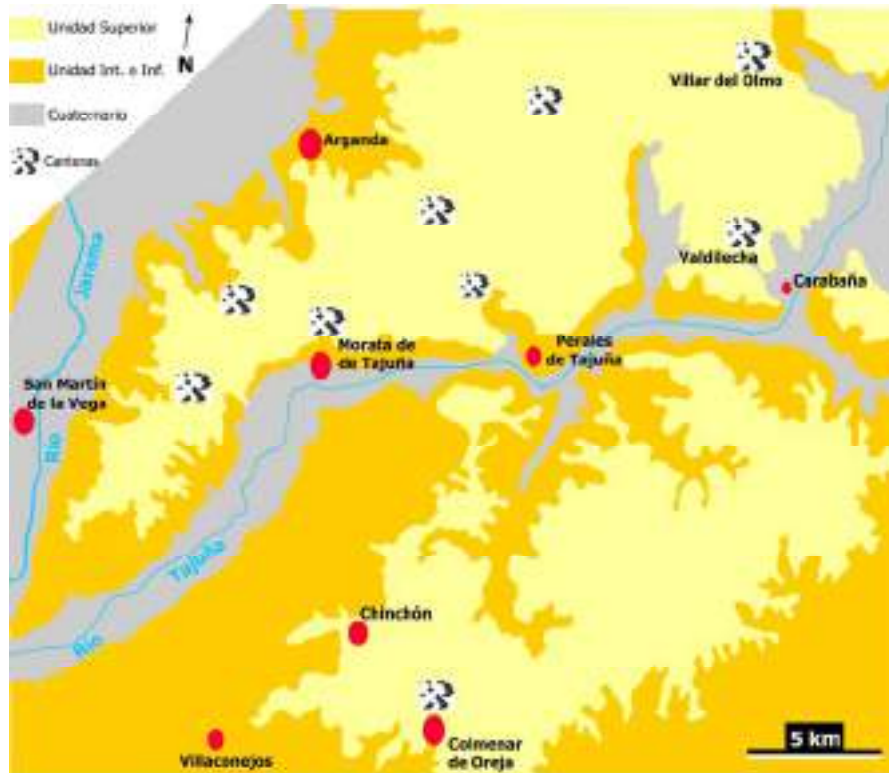
Fig.4.2. Mapa geológico simplificado de los páramos de Chinchón-Colmenar de Oreja y Arganda-Morata de Tajuña y localización de las principales canteras donde la piedra caliza es y/o ha sido explotada (a partir de García del Cura et al. 1999).
