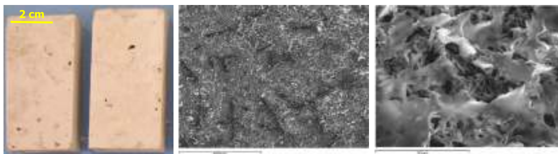
Probetas secas con superficie lisa y exentas de partículas sometidas a una atmósfera saturada en SO 2 antes de efectuar su lavado (izda.), cristales de sulfito cálcico hemidratado (hannebachita) generados durante el ataque ácido (centro) y ruptura del hidrofugante aplicado (dcha.).
