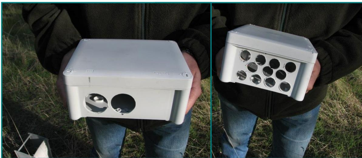
Figura 2.III. Carcasa de protección de los dosímetros pasivos y agujeros para la circulación del aire..
