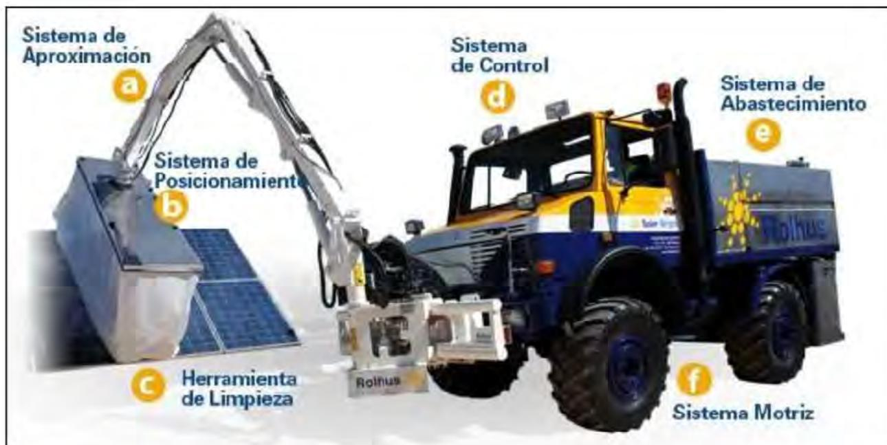
Ilustración 21. Partes de una máquina de limpieza de módulos fotovoltaicos
