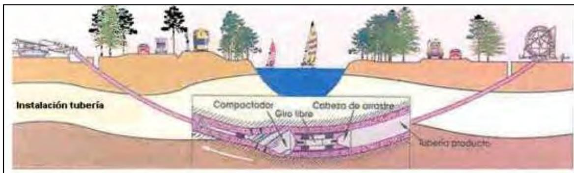
Para los cruces proyectados, la perforación horizontal dirigida será de 500 mm de diámetro, en la que se introducirá una vaina de polietileno del mismo diámetro. La arista superior del tubo protector estará a 5 m del firme en el punto medio para todos los cruzamientos.
