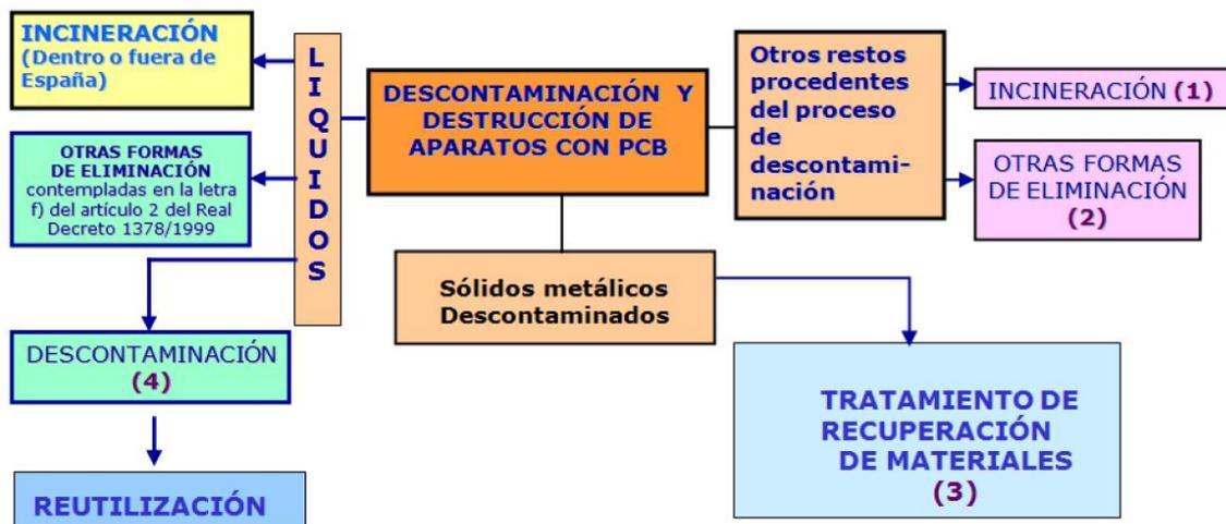
Figura 1. Proceso de tratamiento de aparatos con PCB
