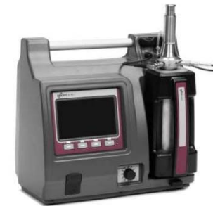
Impactador eléctrico de baja presión (ELPI)
