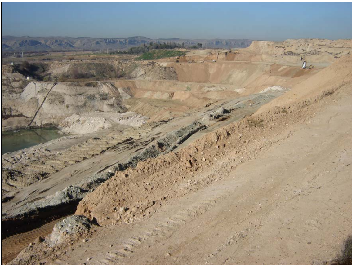
Extracción de grava en bancadas en una de las graveras de la unidad
